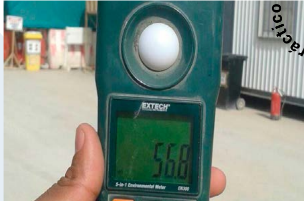
Control de ruido de la obra del metro de Riad (Arabia Saudí)
