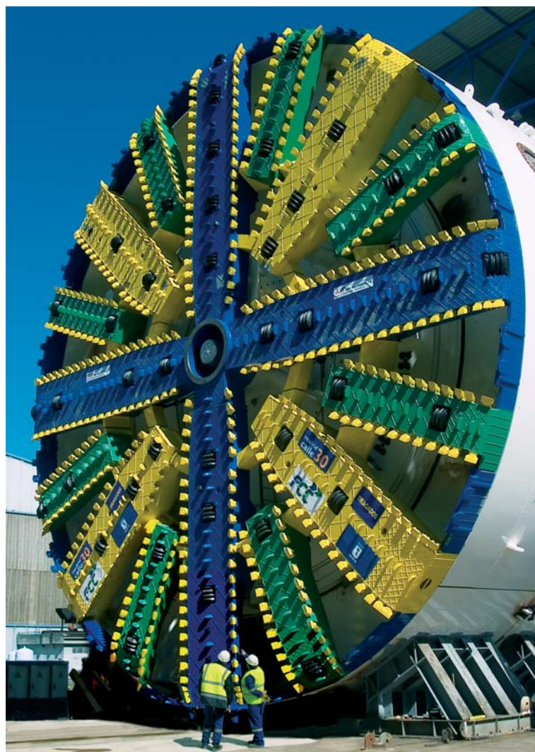
Tuneladora para la ampliación de la M-30. Madrid
